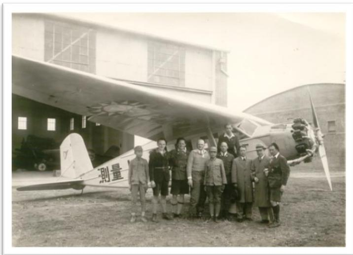
1930年浙江省水利工程局購置的高頂蓋式單發動機空拍飛機 M18D(Messerschmitt)，攝於南京。
